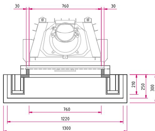
**Hinweis Seitenansicht M 1:25:** AS: Abgasstutzen, VLS: Verbrennungsluftstutzen, OKFF: Oberkante Fertigfußboden
