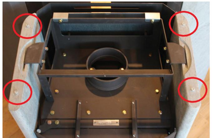
Der AROLA Teefachstein kann durch die 4 Madenschrauben justiert werden (siehe auch Ergänzung im An- hang). Lösen Sie die unterseitige Kontermutter und drehen dann die Madenschrau- be auf die gewünschte Höhe. Kontern Sie die Mutter wieder.
