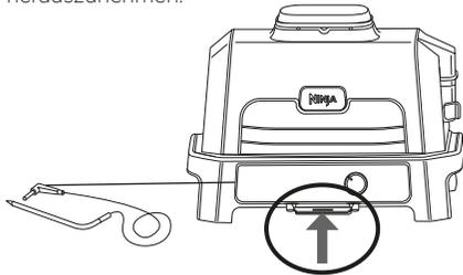
Die Buchse des Bratenthermometers befindet sich links neben dem Drehknopf. Nehmen Sie zur Benutzung zuerst die Schutzabdeckung ab.
