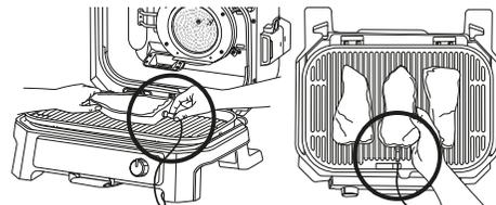
Korrekte Platzierung des Bratenthermometers. Der Griff des Bratenthermometers befindet sich vollständig im Inneren der Einheit.
