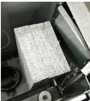
Nun die kurzen Steinplatten auf das Blech stellen.
