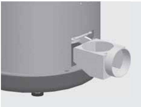
Abb. 3.7 NOVIA C: Anschlusskasten einschieben
