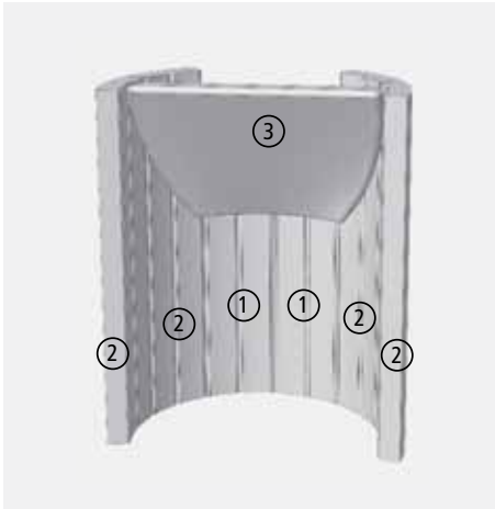
Abb. 7.3 Feuerraumauskleidung NOVIA W
