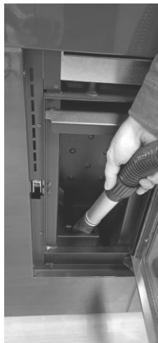
Fig. 35 - Reinigung Fach Brennschale
