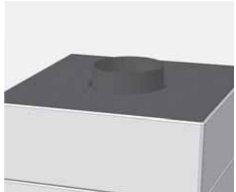
Abb. 3.32 Abgasstutzen oben ersetzen durch drehbaren Abgasstutzen
