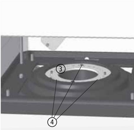
Abb. 3.43 Einstellscheibe für die seitlichen Anschläge ausbauen
