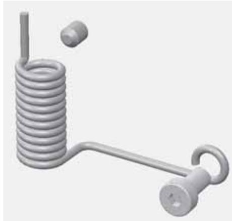
Abb. 3.7 Türfeder, Madenschraube und Spanschraube
