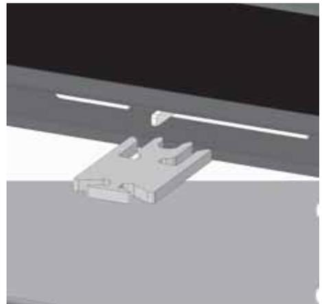
Abb. 3.6 Türsicherung einsetzen
