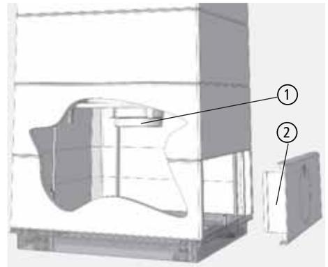
Abb. 3.1 Verbrennungsluftstutzen
