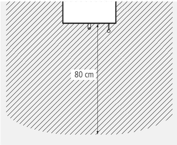
Wegen der hohen Wärmestrahlung über die Sichtscheibe Ihres Kaminofens ist in diesem Bereich ein ausreichender Sicherheitsabstand zu Bauteilen mit oder aus brennbaren Baustoffen oder Einbaumöbeln einzuhalten.
