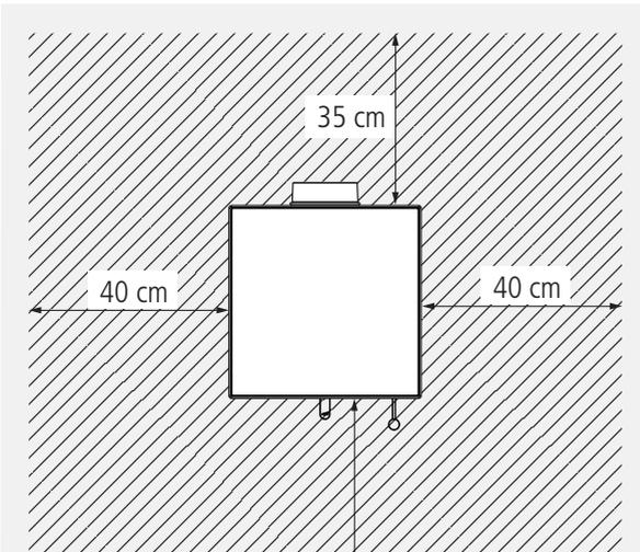
Der Kaminofen muss nach hinten und zu den Seiten Mindestabstände zu temperaturempfindlichen oder brennbaren Baustoffen oder Bauteilen mit brennbaren Bestandteilen einhalten.
