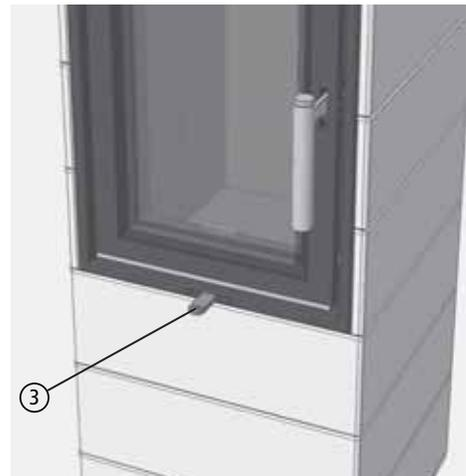
Abb. 4.2 Verbrennungslufthebel
