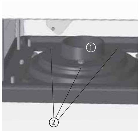
Abb. 3.42 Drehkonsolen-Oberteil abbauen
