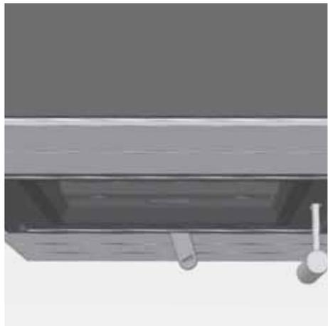
Abb. 4.11 Verbrennungslufthebel ganz rechts, Verbrennungsluft komplett geöffnet, Anheizen
