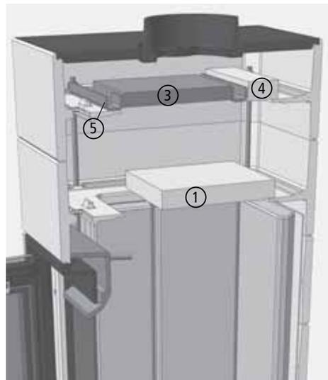
Abb. 3.25 Lage des Katalysators beim CORNA tec, Schnittdarstellung
