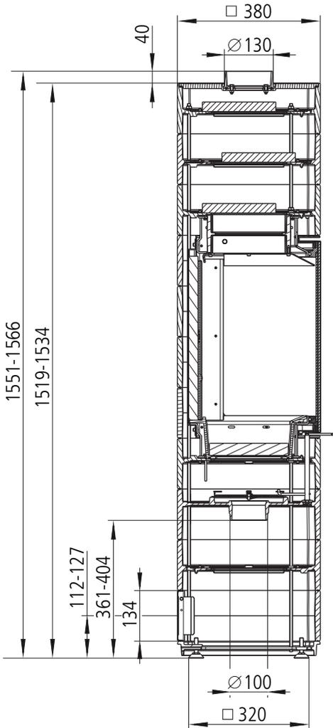
Abb. 3.49 Abgasanschluss, Maße bei Anschlussstutzen nach oben - CORNA PS oder CORNA PS tec
