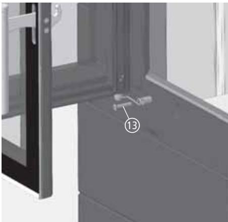
Abb. 3.15 Spannen der Türfeder bei CORNA ES
