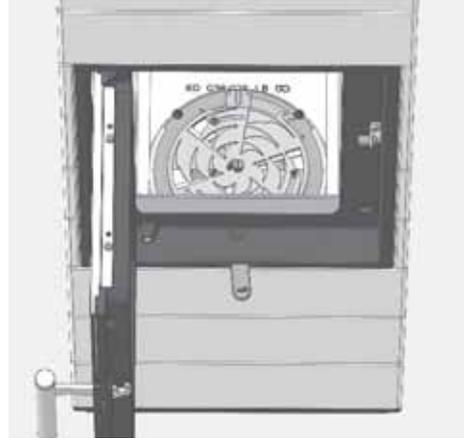
Abb. 3.52 eingebauter VSR auf dem Luftventil
