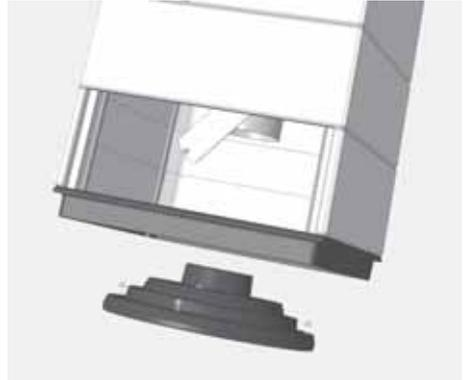
Abb. 3.36 Drehkonsole montieren
