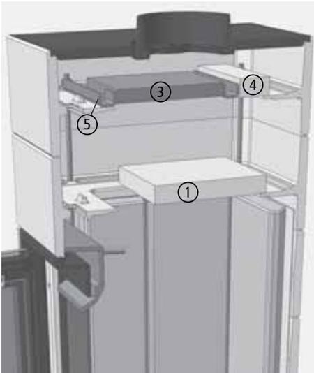
Abb. 3.26 Lage des Katalysators beim CORNA tec, Schnittdarstellung
