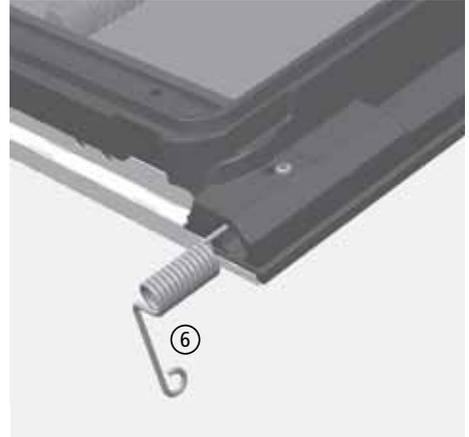
Abb. 3.10 Türfeder einsetzen
