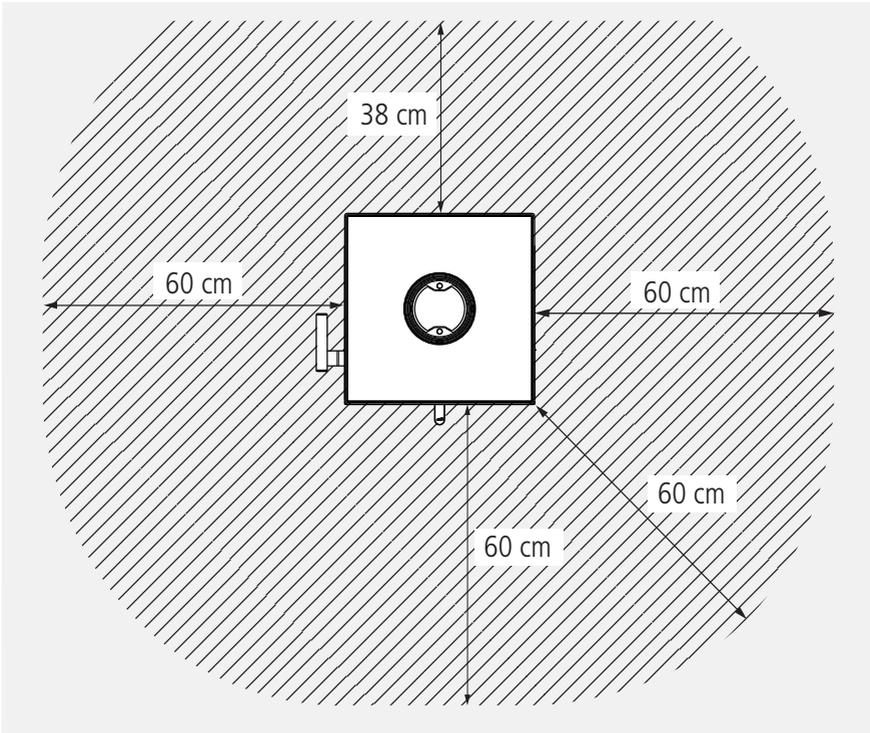
Abb. 1.11 Mindestabstände im Bereich der Sichtscheibe bei CORNA PS und CORNA PS tec
