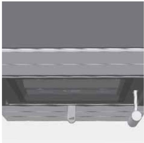
Abb. 4.5 Verbrennungslufthebel mittig, Verbrennungsluft auf Nennwärmeleistung
