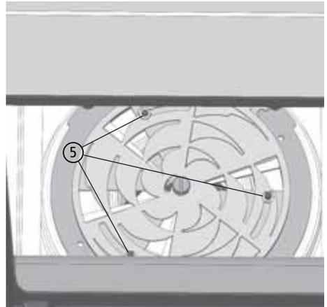
Abb. 3.53 eingebauter VSR auf dem Luftventil
