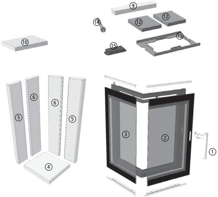
Abb. 5.4 Ersatzteilübersicht für CORNA ES tec
