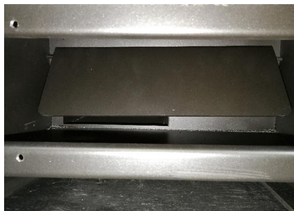
Bild 2: Überprüfen Sie die korrekte Position der Rauchleitplatte.
