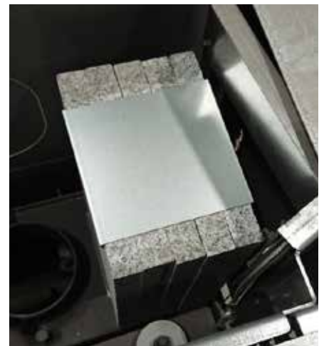
Das Halteblech mit U-Form wie oben abgebildet über die Steinplatten stecken.
