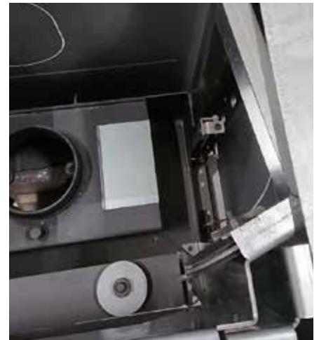
Das Halteblech mit Z-Form wie oben abgebildet einlegen.
