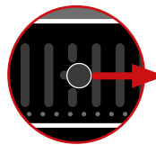
Verbrennungsluft- schieber zu
