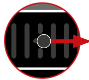
Verbrennungsluft- schieber zu
