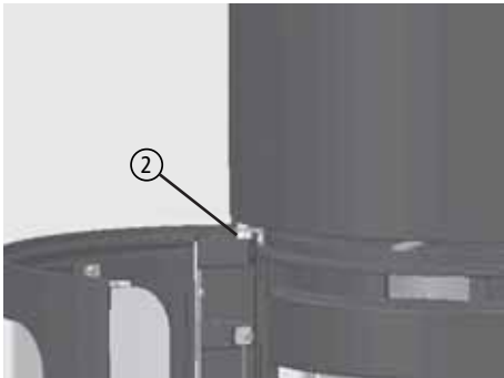
Abb. 3.2 obere Türscharnier-Achse mit Sicherungsclip
