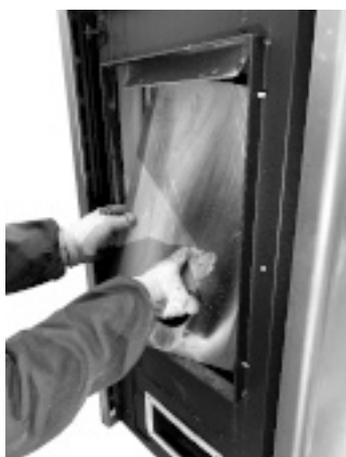
**Fig. 89 - Die Rückseite des Feuerraums entfernen**
