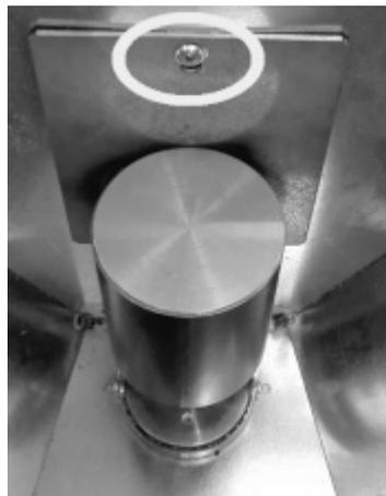
*Fig. 101 - Entfernen der Schraube*
