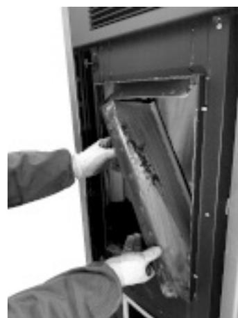
**Fig. 90 - Die Seitenwände entfernen**
