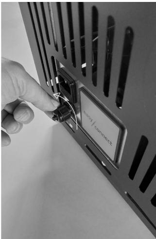
**Fig. 78 - Schrauben Sie die Mutter ab**
