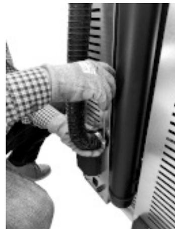
**Fig. 59 - Rohr der Heizluft einstecken**
