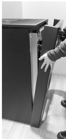
*Fig. 26 - Entfernen die Rahmen*
