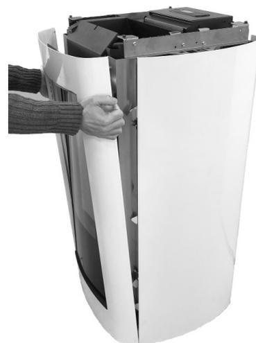
**Fig. 49 - Entfernen die Rahmen**
