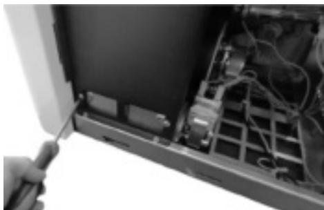
Fig. 97 - Reinigung Raumventilator
