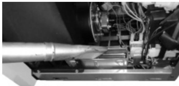
Fig. 98 - Reinigung Raumventilator
