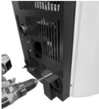
*Fig. 63 - Umlenkblech entfernen*
