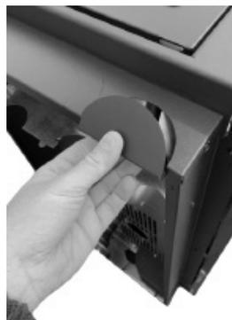
*Fig. 66 - Verschluss entfernen*
