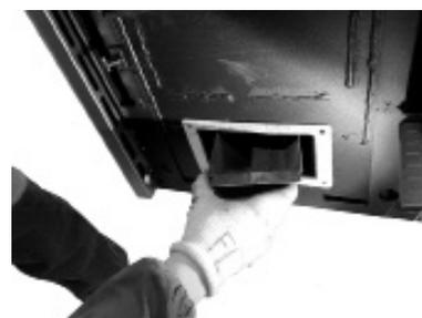
*Fig. 95 - Rauchabweiser entfernen*
