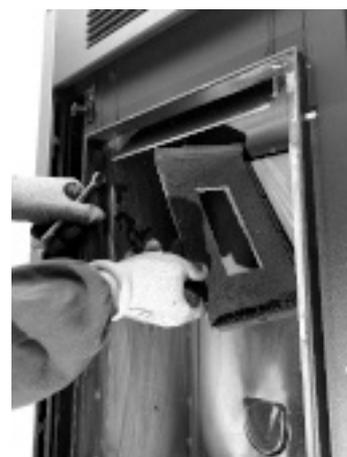
**Fig. 88 - Die Stirnseite des Feuerraums 2 entfernen**
