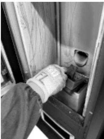
Fig. 80 - Die Brennschale entfernen
