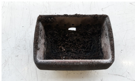
BEISPIEL VERSCHMUTZTE BRENNSCHALE
