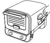
**Ninja Woodfire™ Pellets einfüllen:** Füllen Sie die Pelletschaufel bis zum Rand und entfernen Sie die Pellets, die über den Rand hinausgehen, um ein Verschütten zu vermeiden. Während Sie den Deckel der Smoker-Box offenhalten, geben Sie Pellets in die Smoker-Box, bis er bis zum Rand gefüllt ist. Schließen Sie dann den Deckel der Smoker-Box.
