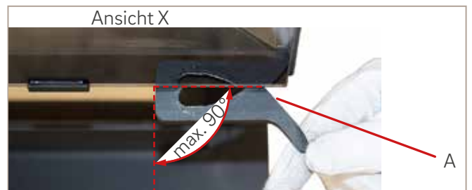
Abb. 44: „Verriegelungshebel unten“ bei 90 Grad geöffnet
