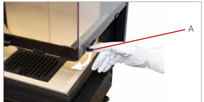
Abb. 42: „Verriegelungshebel unten“ öffnen
