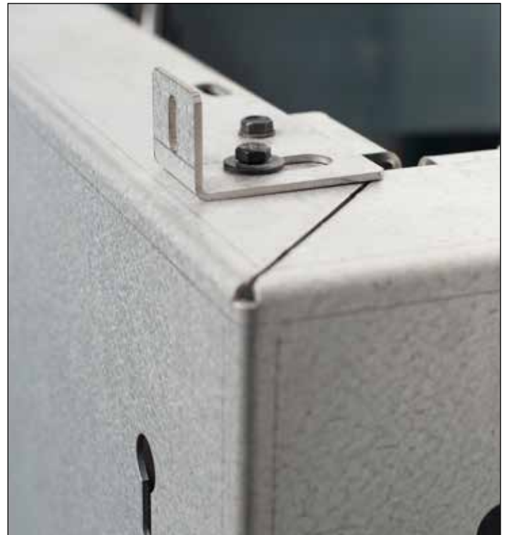
Vorbereitung Montage oberes Keramikelement – Die mitgelieferten Winkel auf der Oberseite der Front mit jeweils einer Beilagscheibe und Sechskantschraube montieren. Jedoch noch nicht fest anziehen.
