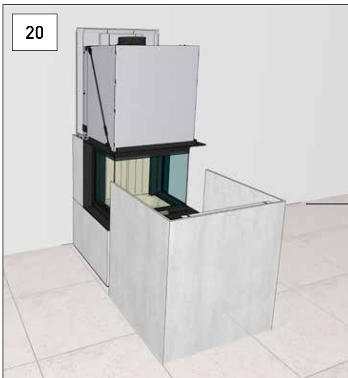
Montage oberes Keramikelement – Vorsichtig das obere Keramikelement auf den oberen Rahmen heben und gleichmäßig nach hinten schieben. So positionieren, dass das Element links, rechts und vorne mit der Zarge bündig ist.
