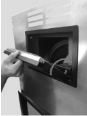
Fig. 70 - Tür in die Ladeklappe fügen
