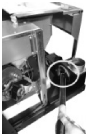
Fig. 113 - Reinigung des Rauchgaskanals
