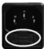
Fig. 116 - Abdeckklappe mit Sicherungen, die ausgewechselt werden müssen
