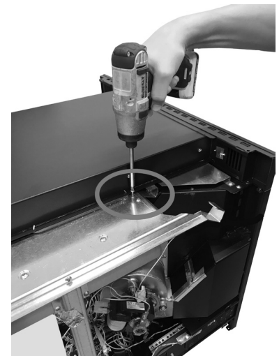
Fig. 56 - Zentrale Befestigung Schublade
