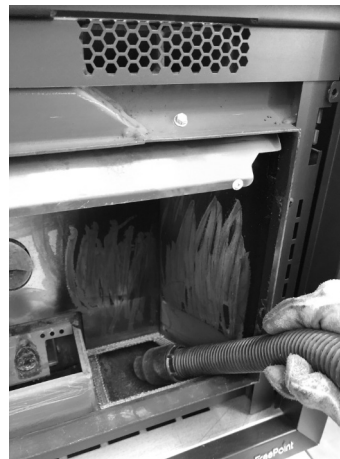
Fig. 103 - Die Asche absaugen
