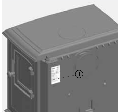
Abb. 7.1 Geräteschild / Typenschild auf der Geräterückseite
