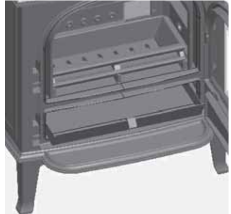
Abb. 4.14 Entnehmen des Aschekastens
