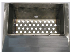
Kohlebecken gut sauber mit allen Löchern gut sichtbar
